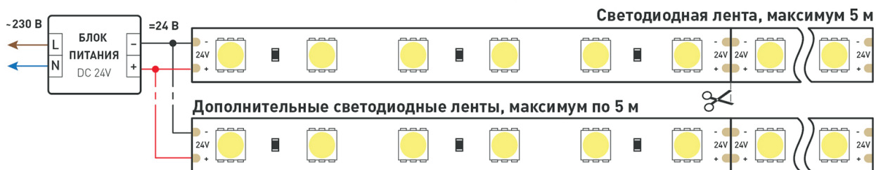
Схема 1. Подключение нескольких светодиодных лент с одной стороны.
