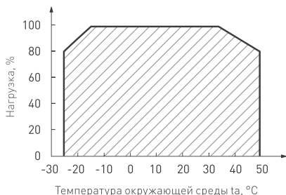
Рис. 2. Максимальная допустимая нагрузка, % от мощности источника
