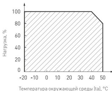
Рис. 2. Максимальная допустимая нагрузка, % от мощности источника
