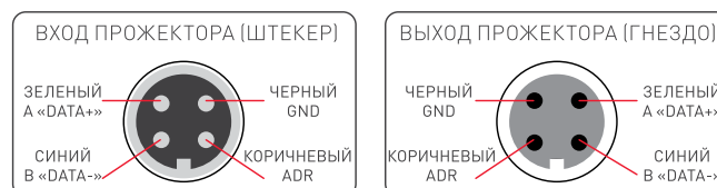
Цоколевка коннекторов на сигнальных кабелях
